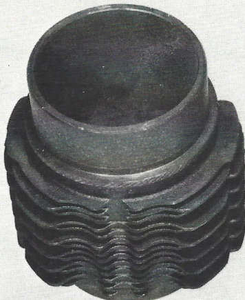
A gauche : cylindre en fonte de LN. A droite : cylindre en alliage léger de LNA. (Photo Legros. Citroën 32.68).
